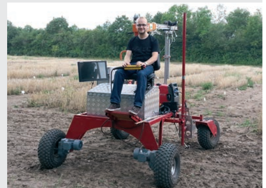
Melchert bei Versuchen auf dem Agrover in einem Zuchtgarten. Mit dem Forschungsfahrzeug lassen sich hyperspektrale Bilddaten aufnehmen.
