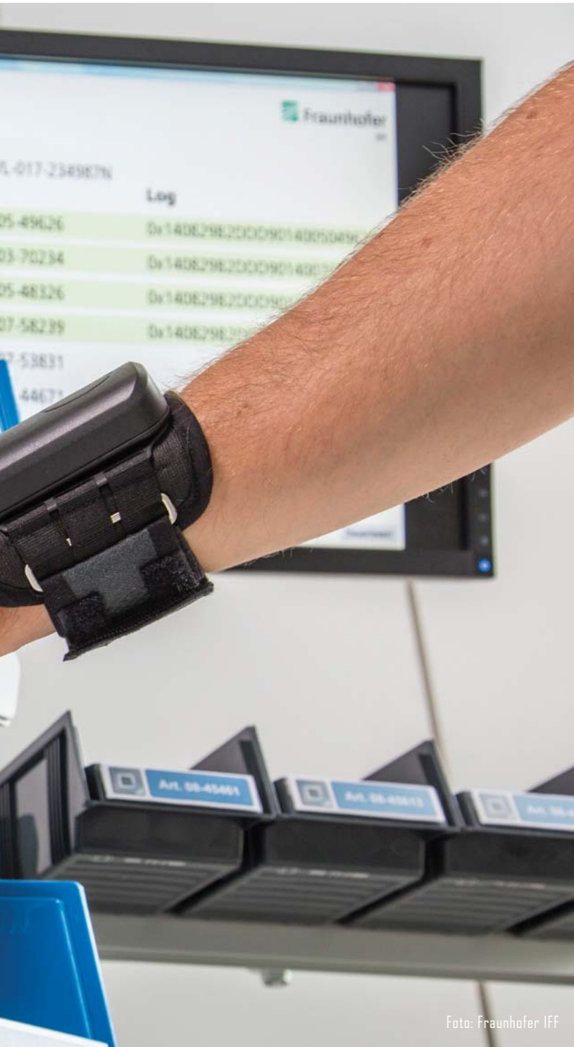
Mit dem RFID-Armband ist das Greifen kleiner Bauteile deutlich schneller und sicherer geworden. Im Praxistest bei der Volkswagen Originalteile Logistik GmbH & Co. KG hat es sich bewährt.
