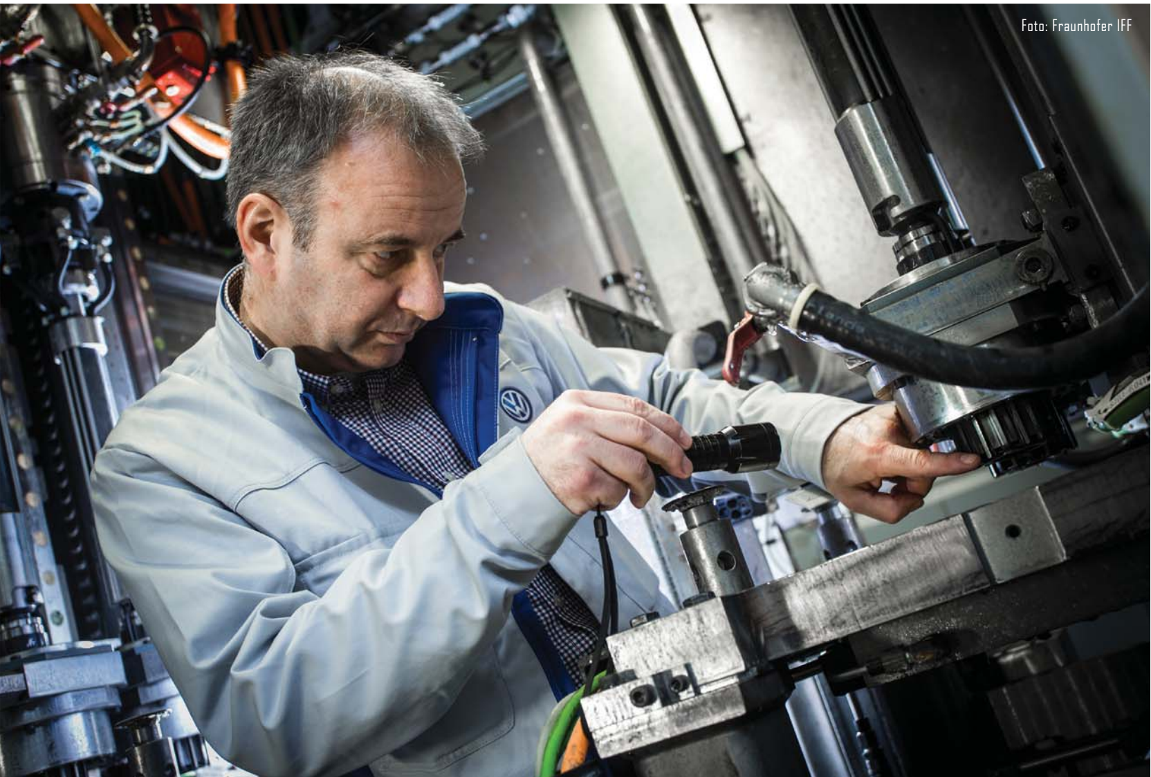
Jörg Rudolph, technischer Fachreferent bei VW, prüft, ob die Honwerkzeuge beschädigt sind.
