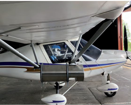
Die Luftbilderfassungseinheit wird an den Flügel der Kleinflugzeuge montiert. Bilder: Fraunhofer IFF
