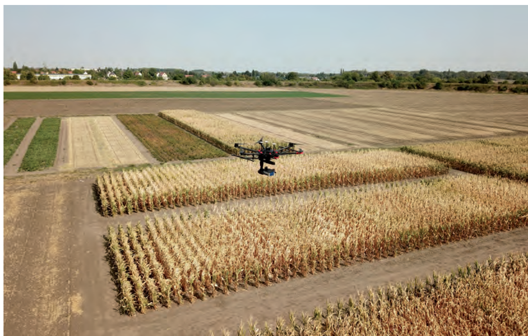
Für schnelle Analysen setzen die Forscher Drohnen ein. Sie sind zwar weniger präzise als die langsamen »AgRover« am Boden, liefern im Überflug über die Versuchsfelder aber im Bruchteil der Zeit eine große Menge Daten. Foto: David Killias
