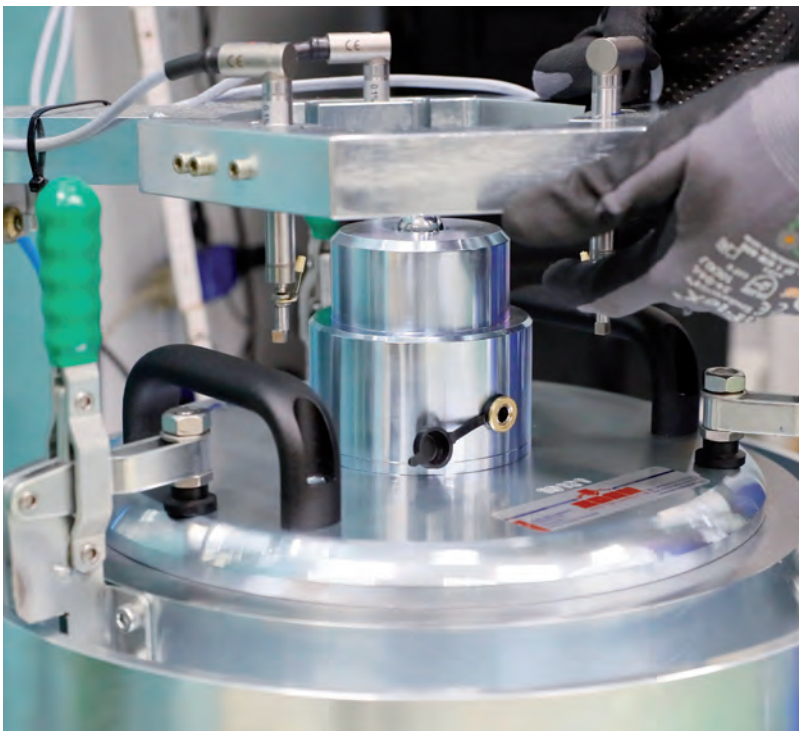
Manueller Prüfstand für Fallgewichtsgeräte in der Firma Zorn Instruments. Bei diesem Prüfvorgang muss ein Mitarbeiter die Fallgewichte von bis zu 15 Kilogramm Masse handhaben. Fotos: Zorn Instruments, Danny Kurz
