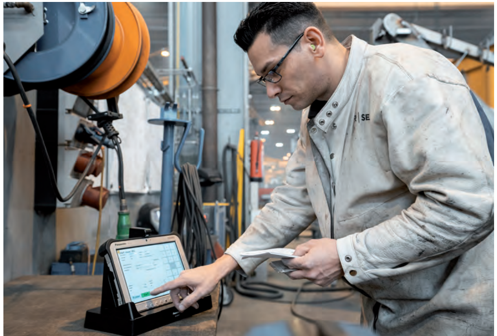
Das Assistenzsystem ViWIS führt Informationen aus verschiedenen Systemen zusammen. Der Werker meldet sich zu Beginn mit seiner Mitarbeiterkarte im mobil verfügbaren Betriebsdatenerfassungssystem (BDE) an seinem Tablet an.
