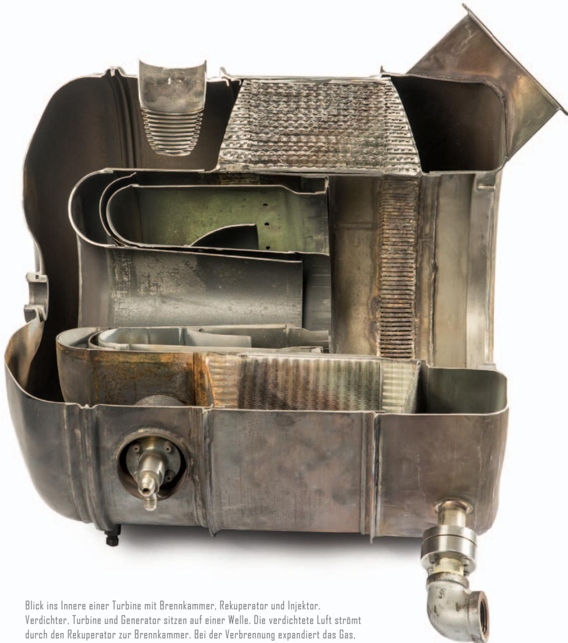
Blick ins Innere einer Turbine mit Brennkammer, Rekuperator und Injektor. Verdichter, Turbine und Generator sitzen auf einer Welle. Die verdichtete Luft strömt durch den Rekuperator zur Brennkammer. Bei der Verbrennung expandiert das Gas, strömt durch die Turbine und treibt Verdichter und Generator an. Foto: Dirk Mahler
