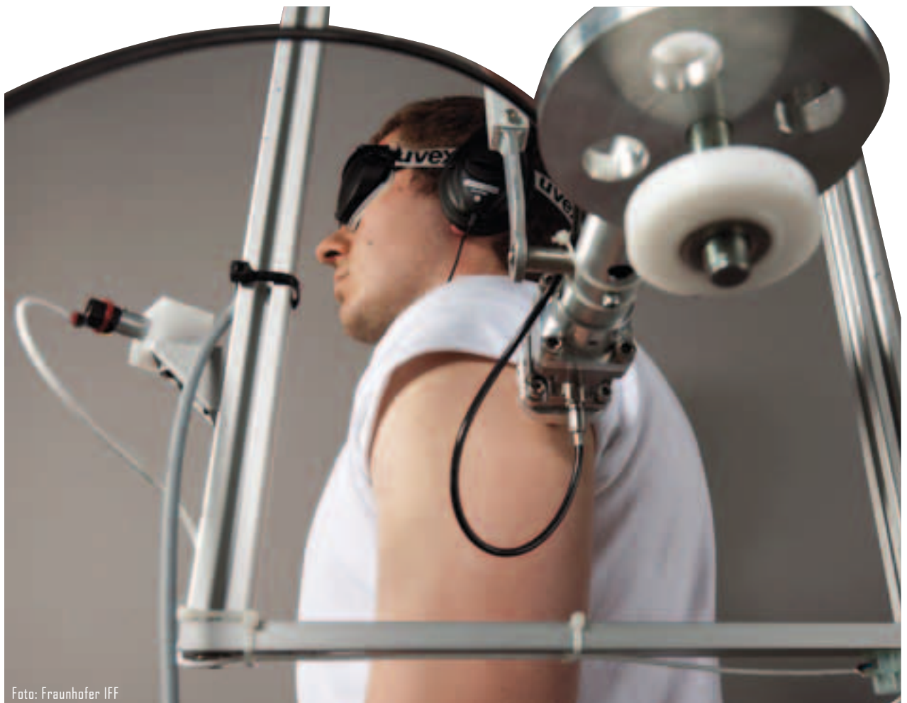
Proband bei der Stossuntersuchung der Studie. Wieviel Kraft darf auf den menschlichen Körper wirken, bis ein blauer Fleck entsteht?
