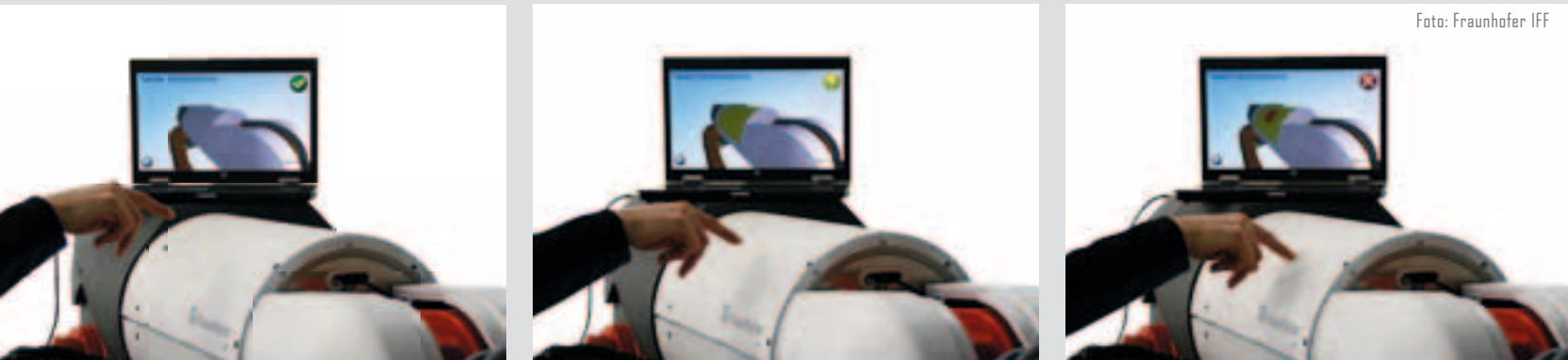
Mit der Sensorhaut merkt der Roboter nicht nur, dass sich jemand nähert, sondern auch, aus welcher Richtung.
