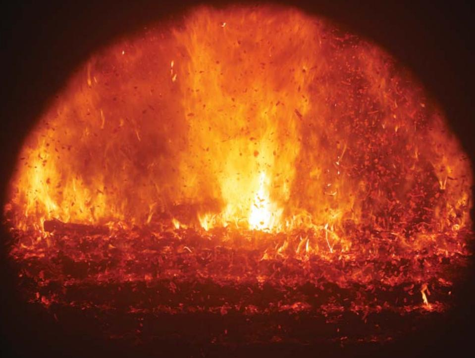
Verbrennungsanlage zur Energiegewinnung. Anhand des Bilds der Flammen lässt sich ablesen, wie die Verbrennung läuft. Sensoren können mit Hilfe neuronaler Netzwerke trainiert werden, die optimale Verbrennung zu erkennen.
