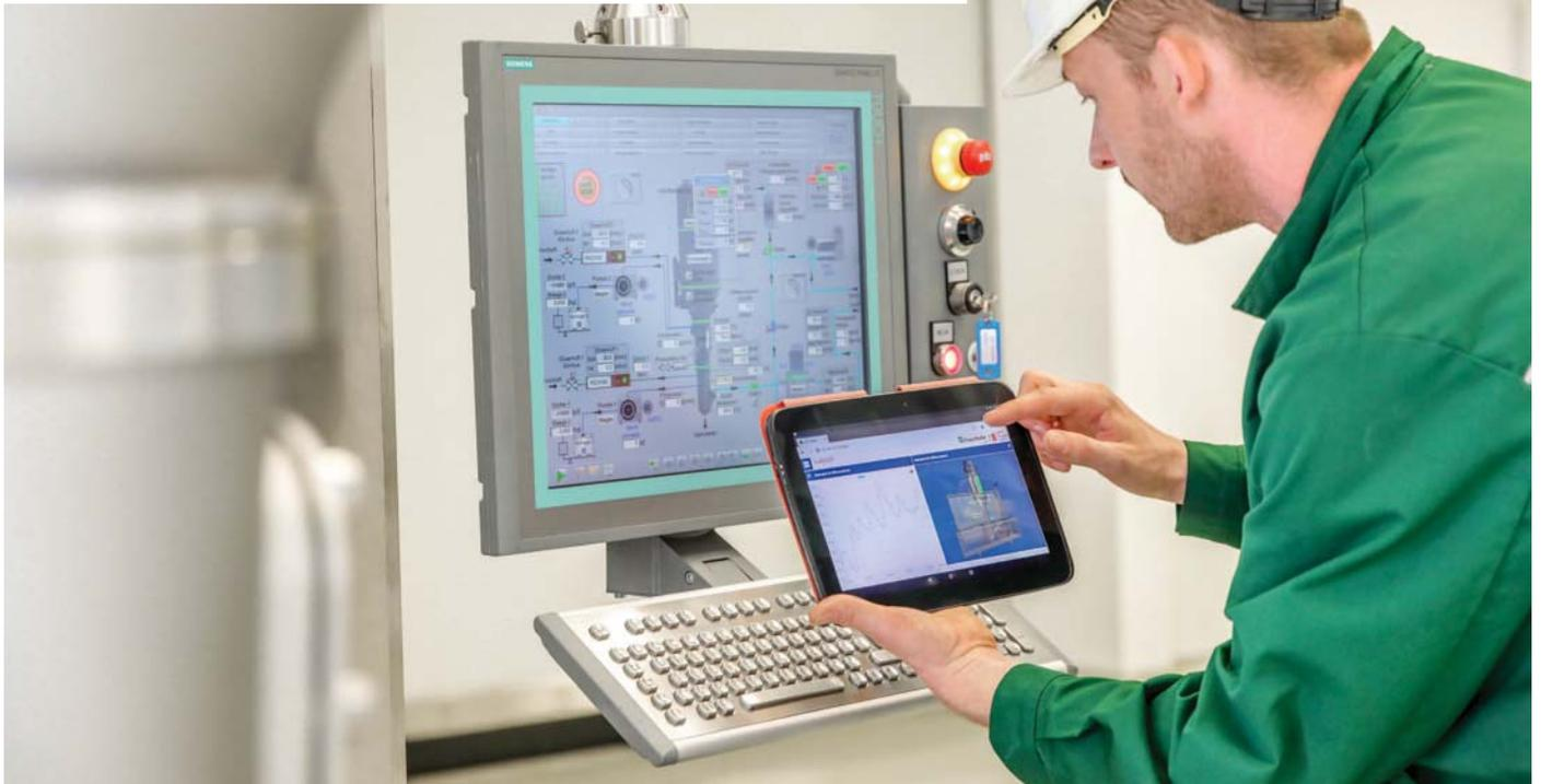
Digitale Unterstützung auf dem Tablet. Ist eine Anlage defekt, wird dem Techniker auf dem Tablet mittels AR-Unterstützung das betreffende Bauteil auf das Bild der realen Anlage projiziert. Er kann sich beispielsweise die Temperatur- und Druckverläufe ansehen, die Bauteile virtuell einblenden oder Anweisungen anzeigen lassen – er hat mit einem Klick alle relevanten Informationen zur Hand. Fotos: Fraunhofer IFF, Viktoria Kühne
