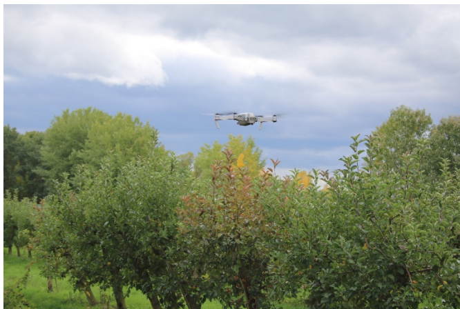
Abb. 2 Mit einer Drohne verschaffen sich die Wissenschaftler einen Überblick über die gesamte Obstanlage. Zukünftig sollen die Krankheitssymptome direkt anhand der spektralen Signatur aus Drohnen- oder Satellitenbildern ermittelt werden.
