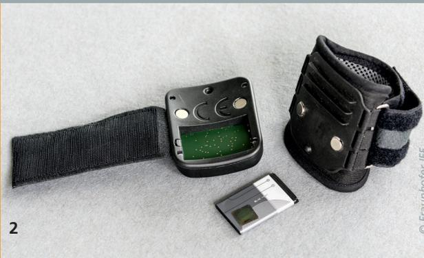
1 Das RFID-Armband zur Identifikation von Greifbereichen in Montageprozessen.
